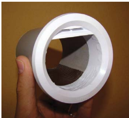
Upravená mriežka HACO 75 s odstránenými lamelami a prilepenou sieťovinou na spodku rúrky, ktorá zabezpečuje zdrsnenie miesta pohybu živočíchov.
